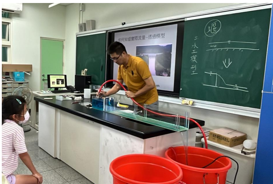
圖 12 圳路水工模型實驗
